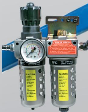
Die Drucklufteinheit besteht aus einem Druckluftfilter mit Regler und einem Nebelöler. Am oberen Verstellknopf kann der Druck der Drucklufteinheit eingestellt werden. Der Knopf wird durch Herausziehen gelöst. Beim Drehen im Uhrzeigersinn wird der Druck erhöht, beim Drehen gegen den Uhrzeigersinn wird der Druck reduziert. Um ein versehentliches Verstellen zu verhindern, kann der Knopf in der Ausgangslage fixiert werden.
